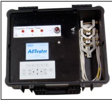
Переносной прибор марки «AC-Tester» (Absorption Current Tester) предназначен для оценки технического состояния изоляции высоковольтного оборудования в режиме «off-line». «AC-Tester» может быть использован для определения параметров кабельных линий с бумажно-масляной
