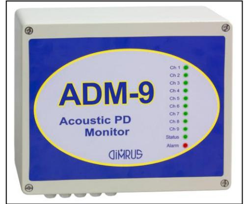
Система мониторинга «ADM-9» (Acoustic PD Monitor) предназначена для оперативного контроля технического состояния и поиска дефектов изоляции высоковольтного оборудования под рабочим напряжением. В системе «ADM-9» диагностика осуществляется на основе метода регистрации и анализа частичных разрядов, который имеет максимально высокую чувствительность при поиске дефектов в изоляции любого типа.
