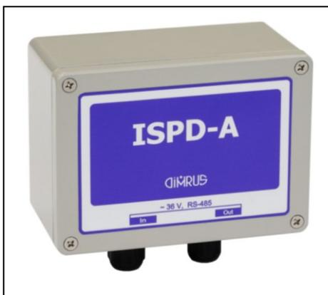
Питание базового модуля осуществляется от напряжения ~220В. Для питания датчиков ISPD-A используется переменное напряжение ~36В от трансформатора в базовом модуле. Это позволяет синхронизировать в датчиках процесс измерения частичных разрядов с фазой синусоиды питающей сети, что необходимо для выявления типа дефекта в изоляции и оценки его опасности.
