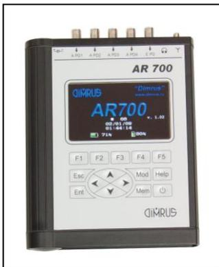
Переносной прибор марки «AR700» применяется для регистрации и анализа акустических сигналов на внешней поверхности элегазовых выключателей и подстанций, силовых трансформаторов и другого бакового высоковольтного оборудования. Причина появления таких акустических сигналов – частичные разряды в изоляции, сопровождающие
