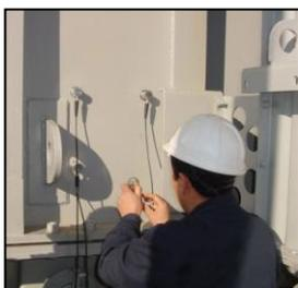
Для проведения локации места возникновения дефекта внутри бака оборудования, на его поверхности определенным образом устанавливаются 4 акустических датчиков. Основным диагностическим фактором является регистрация одновременности прихода импульсов частичных разрядов к
