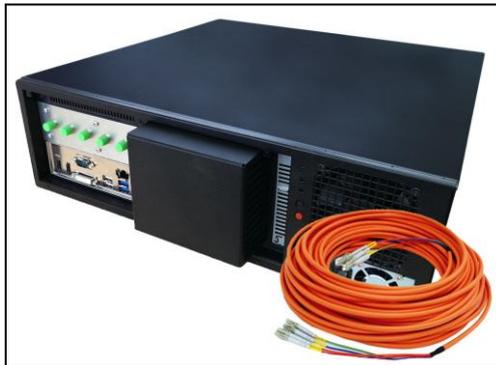
Локальная температура на каждом конкретном участке кабельной линии рассчитывается с использованием разницы во времени между моментом времени получения отраженного от каждого участка импульса и моментом излучения лазерного импульса в оптическое волокно. Зная скорость распространения света в измерительном оптоволокне, можно с высокой точностью
