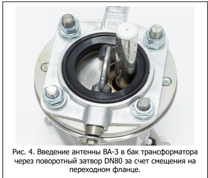
Рис. 4. Введение антенны ВА-3 в бак трансформатора через поворотный затвор DN80 за счет смещения на переходном фланце.
