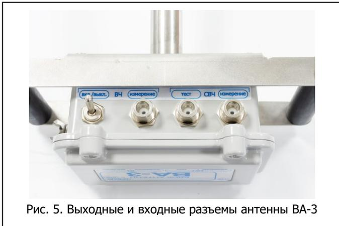
Рис. 5. Выходные и входные разъемы антенны ВА-3
