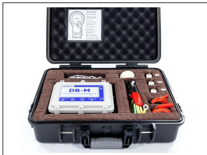
Для контроля параметров одного ввода и проведения диагностики дефектов, а также для регистрации частичных разрядов в изоляции ввода и обмоток самого трансформатора, возможна поставка комплекта однофазного устройства присоединения DB-M.
