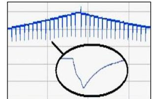
На рисунке приведены осциллограммы работы РПН при переходе из положения 6 в положение 5 для трансформатора, имеющего дефекты в переключающем устройстве. Для временного ориентира на нижнем графике для фазы «С» приведена осциллограмма работы контактора
