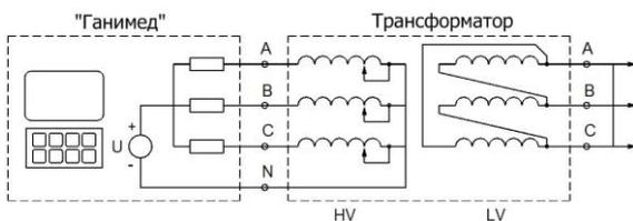
Схема подключения прибора «Ганимед» при использовании данного метода диагностики РПН представлена на рисунке. На этой схеме вторичная обмотка силового трансформатора замкнута накоротко, а по первичной обмотке от прибора протекает постоянный ток, равный 1А или 2А.
