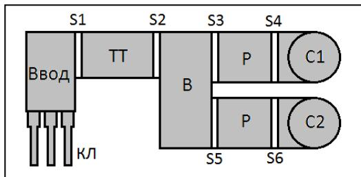
В состав контролируемой элегазовой секции входит корпус кабельных вводов, измерительный трансформатор тока ТТ, выключатель В, два разъединителя Р для коммутации секций шин С1 – С2. При помощи комплекта из шести датчиков S<sub>1</sub> – S<sub>6</sub> осуществляется контроль состояния изоляции не только всех элементов КРУЭ и локация места возникновения дефектов, но и производится контроль состояния изоляции высоковольтных кабельных линий.
