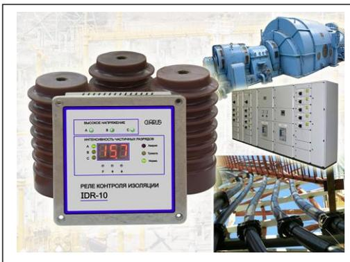
Измерительный прибор «IDR-10» монтируется на лицевой панели КРУ. Три светодиодных индикатора реле показывают наличие напряжения на шинах КРУ, соответствие номинальному диапазону отклонений напряжения. Интенсивность частичных разрядов показывается при помощи цифрового индикатора. При превышении аварийного уровня разрядов производится включение пороговых светодиодов и выходного электромагнитного реле.
