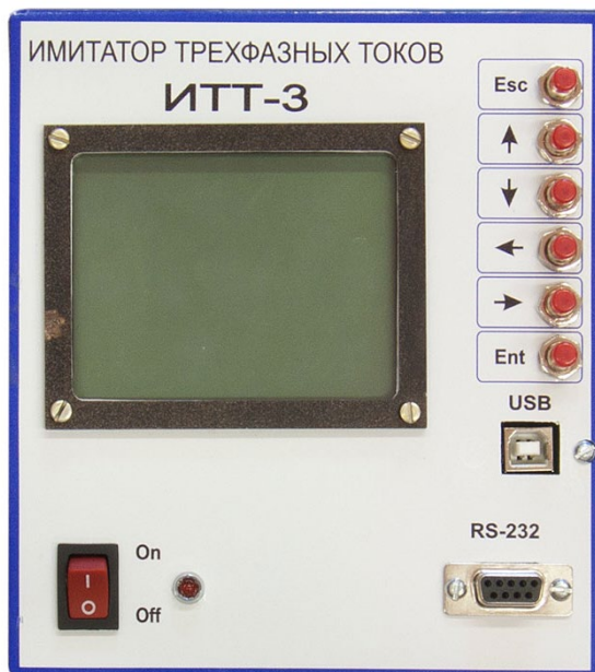
Рисунок 3. Внешний вид панели управления прибора «ИТТ-3»
