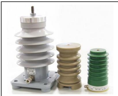
Внешний вид некоторых конденсаторов связи приведен на фото. Слева показан конденсатор связи, допускающий наружную установку, справа приведены два конденсатора связи, предназначенные для установки непосредственно внутри корпуса статора электрической машины. По форме и своим размерам они напоминают стандартные опорные изоляторы, так как часто, по причине доступности и удобства, монтируются на их место.
