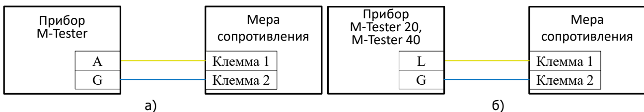
Рисунок 9.18 – Схема измерения электрического сопротивления изоляции
