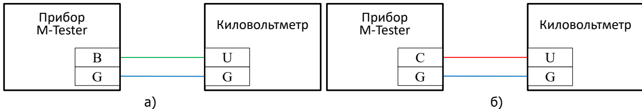
Рисунок 9.16 – Схема измерения постоянного напряжения, создаваемого прибором M-Tester: а) на клемме «В»; б) на клемме «С»
