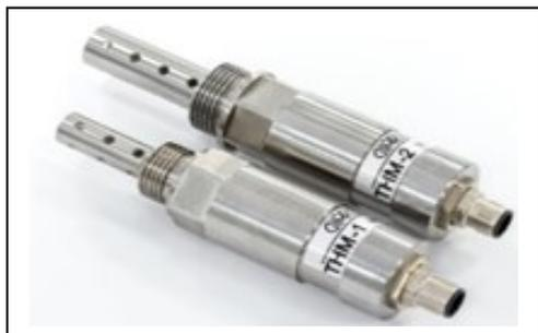
Более оптимальным является вариант использования специализированных датчиков контроля влагосодержания в масле, устанавливаемых на баке трансформатора. Чувствительный элемент этих датчиков находится непосредственно в масле бака. В качестве примера здесь приведена фотография датчиков марки ТНМ-1 и ТНМ-2 фирмы ДИМРУС.
