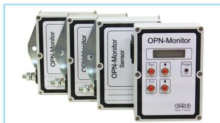
Центральный модуль системы «OPN-Monitor» имеет встроенные экран и клавиатуру. При помощи этих элементов обеспечивается прямой доступ к внутренним настройкам параметров системы. При помощи центрального модуля можно просматривать текущую информацию по всем контролируемым ОПН. Связь центрального модуля системы с переносным компьютером может быть осуществлена при помощи интерфейса USB.
