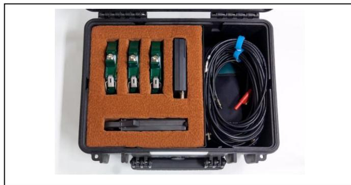
Набор датчиков марки «PD Sensors - CL» предназначен для проведения измерений в изоляции высоковольтных кабельных линий. Он включает в себя 3 датчика марки «RFCT-4», датчик емкостных токов утечки в экранах кабельной линии промышленной частоты, и тестовый калибратор марки «GTI-R» для калибровки длинных кабельных линий.
