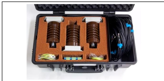
Набор марки «PD Sensors - RM» предназначен для проведения измерений в обмотках статоров высоковольтных электрических машин. В набор включены три высоковольтных конденсатора связи марки «CC-12/U» и один датчик марки «DRTD-3». «DRTD-3» используется для подключения к датчикам температуры, встроенным в обмотку статора. Датчики температуры работают как антенны для регистрации частичных разрядов внутри обмотки.
