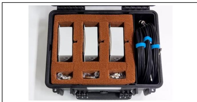
Набор марки «PD Sensors - GIS» предназначен для проведения измерений в высоковольтном элегазовом оборудовании. В набор входят три накладных датчика частичных разрядов марки «AES», защитные индуктивности OVP-1 и соединительные кабели.
