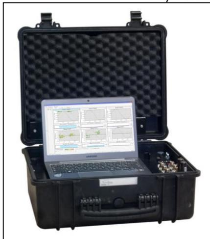
С помощью этой экспертной системы производится сравнение полученных концентраций газов с нормированными пороговыми значениями, строится треугольник Дюваля, проводится сравнительная оценка соотношений концентраций характерных газов.
