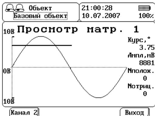
Рисунок 2.12. Просмотр амплитудно-фазового распределения. Частичные разряды от имитатора «ИТТ-2»
