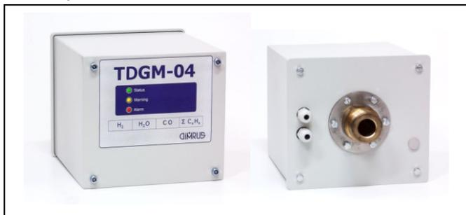
Для монтажа на баке трансформатора применяется конструкция газоанализатора в виде отдельного прибора, который монтируется на сливном кране бака трансформатора при помощи переходного фланца.
