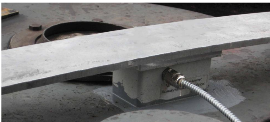
Рисунок 3.8.3. Пример установки коммутационного блока.
