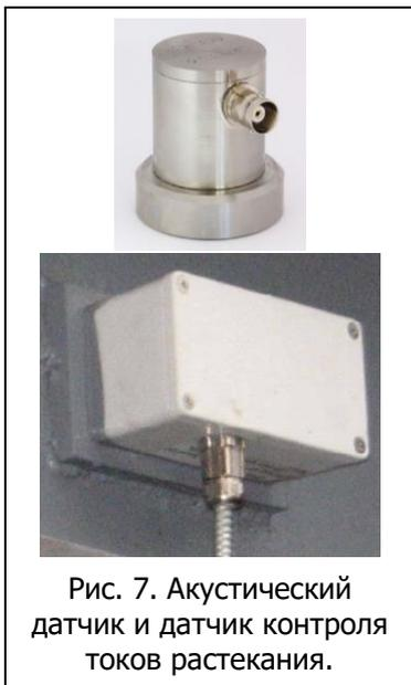
Рис. 7. Акустический датчик и датчик контроля токов растекания.
