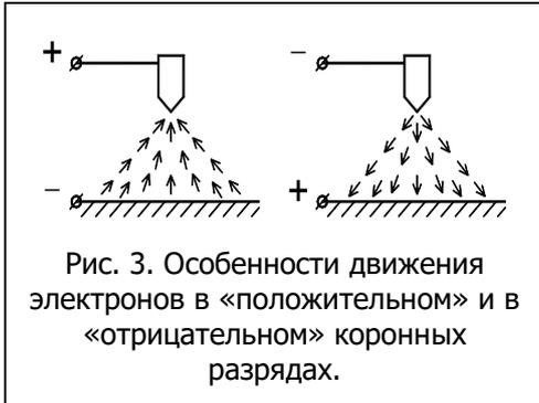
Согласно рисунку 3 на положительной полуволне сетевого напряжения электроны с земляного потенциала стекают к выступу на высоковольтном электроде, многократно усиливая свою энергию. При отрицательной полуволне напряжения электроны растекаются от высоковольтного электрода, по пути теряя свою энергию.
