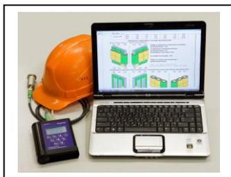
Усилие осевой прессовки обмоток высоковольтных силовых трансформаторов определяет их динамическую стойкость к сквозным токам короткого замыкания, которые могут протекать через трансформатор в
