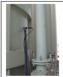
Информация о вибрации бака трансформатора в процессе проведения измерений записывается в память прибора. Ее объем достаточен для хранения информации об обследовании более чем 40 трансформаторов. Далее данные из прибора передаются в компьютер, где накапливаются и хранятся в базе данных экспертной программы «Веста».
